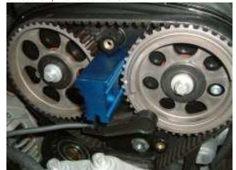
Abb15 Spannrolle mit der Lasche in der Nut montieren
