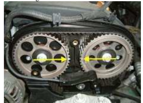
Abb14 Fixierwerkzeug der Nockenwellen einsetzen, -falls vorhanden
