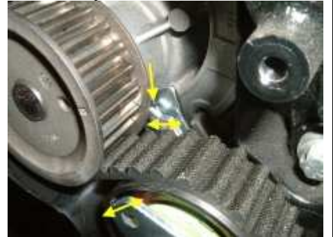
Abb16 Vorspannung der Zahnriemenspannrolle einstellen
