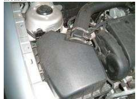
Abb7 Luftfilterkasten mit Ansaugschlauch abbauen
