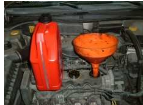
Abb18 Neues Motoröl einfüllen
