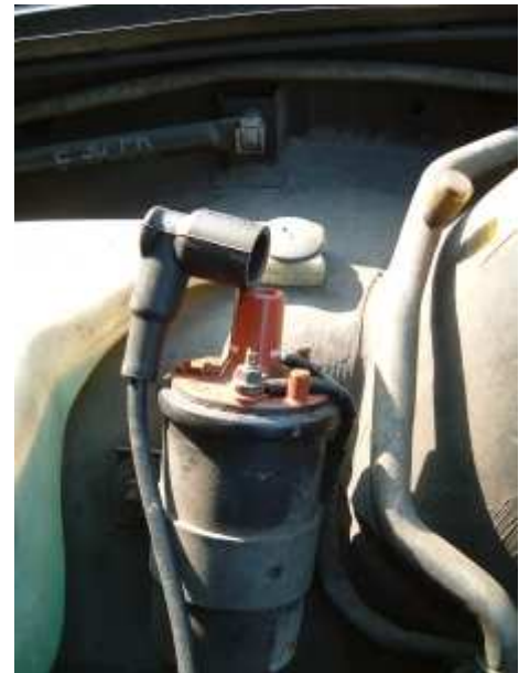
Abb7 Zündfunken sprung durch abziehen und anlegen des Hochstromkabel testen
