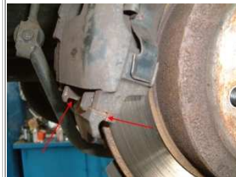
Abb.15 Korrekten Sitz der Bremsklötze beachten
