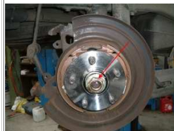
Abb.15 Korrekten Sitz der Bremsklötze beachten
