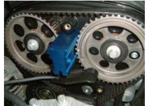
Abb15 Spannrolle mit der Lasche in der Nut montieren
