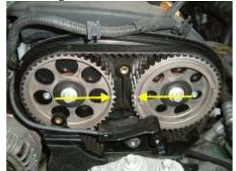
Abb14 Fixierwerkzeug der Nockenwellen einsetzen, -falls vorhanden
