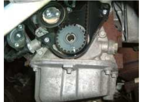
Abb13 Die Markierungen der Nockenwellen müssen gegenüberstehen
