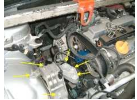
Abb11 a Motorbock demontieren
