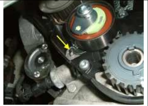
Abb16 Vorspannung der Zahnriemenspannrolle einstellen
