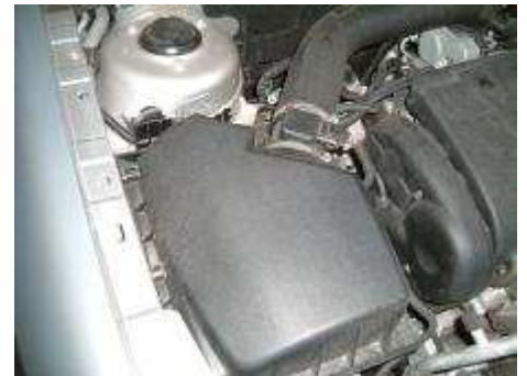
Abb7 Luftfilterkasten mit Ansaugschlauch abbauen
