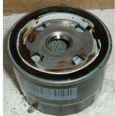
Abb15 Gummidichtring mit Öl benetzen
