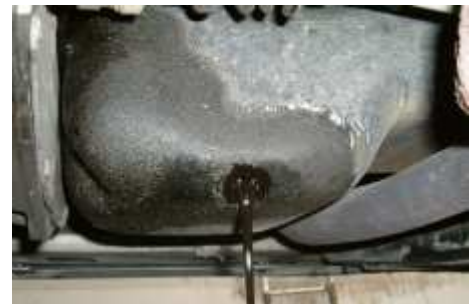
Abb12 Das Motoröl läuft ab
