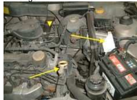
Abb19 Ölstand prüfen und Ölzettel einhängen
