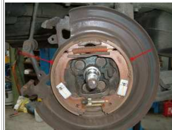
Abb.12 Lauffläche der Bremsbacken abschmiegeln
