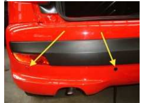
Abb17 Die Löcher bohren, dank des mitgelieferten Fräser, passen die Sensoren genau.
