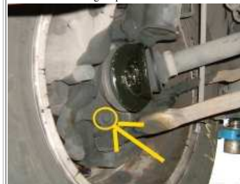
Abb.18 Schraube Kugelkopf entfernen
