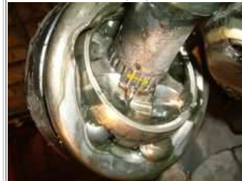
Abb.20 Der elende Sicherungsring
