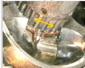
Abb.21 Der elende Sicherungsring in Nahaufnahme
