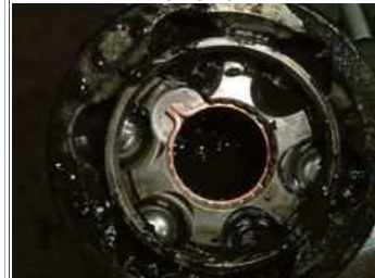
Abb.23 Neuen Sicherungsring eingesetzt
