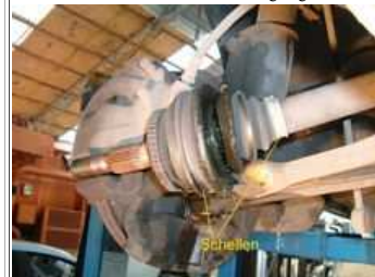
Abb.19 Antriebswelle aus Radnabe rausgezogen
